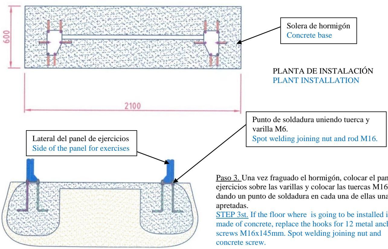
Paso 3. Una vez fraguado el hormigón, colocar el panel de ejercicios sobre las varillas y colocar las tuercas M16, dando un punto de soldadura en cada una de ellas una vez apretadas.
