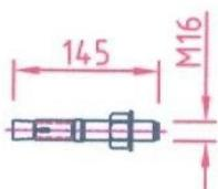
Opción B: Si el suelo donde se va a instalar está hormigonado, sustituir las garras por 12 espirros de M16x145mm. Dar punto de soldadura uniendo tuerca y espirro.
