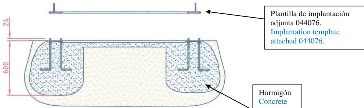
Paso 1. Horadar en el sitio a instalar hueco según gráfico 2100x600x600mm y hormigonar sin dejar aristas cortantes.
