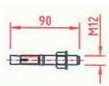
Opción B: Si el suelo donde se va a instalar está hormigonado, fijarlo al suelo con 4 espirro de M12x90mm. Dar punto de soldadura uniendo tuerca y espirro.
