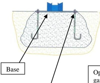
**Paso 3.** Una vez fraguado el hormigón, colocar el juego de pedales sobre las varillas y colocar las tuercas M8. Dar un punto de soldadura en cada una de ellas una vez apretadas.
