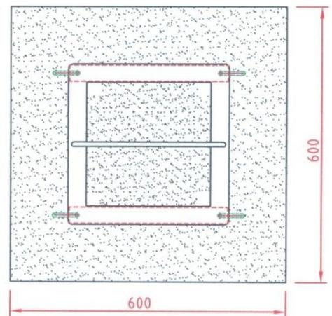
**Paso 1.** Horadar en el sitio a instalar hueco de 600x600x300mm. y hormigonar sin dejar aristas cortantes.
