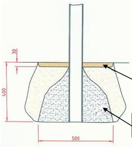
Paso 1. Horadar en el sitio a instalar 1 hueco de 500x500x400mm , introducir el punto informativo y hormigonar sin dejar aristas cortantes dejando una profundidad de 3 cms desde la solera a línea de tierra.
