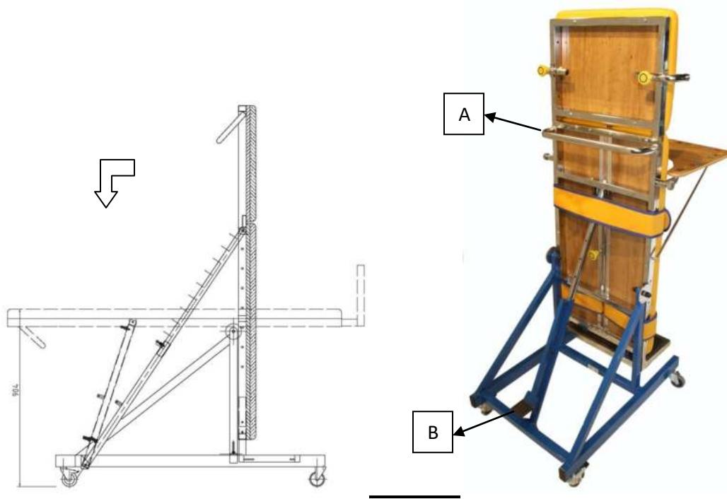
Para bascular el plano a la posición horizontal, pisar sobre el pedal B y mientras ayudar el movimiento tirando desde el asidero A hacia la dirección de la flecha indicada.
