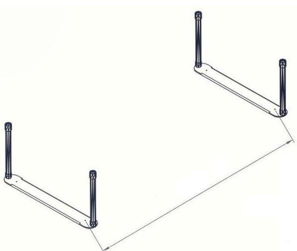
1 Las paralelas se suministran con los tubos tinteros en las bases lastradas. Colocar las bases lastradas a la distancia indicada en la sección de medidas de cada paralela.
